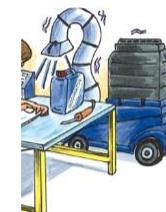
El sistema de extracción debe estar colocado lo más cerca posible de la fuente donde se generan los vapores o aerosoles y encerrar lo máximo el foco. Debe someterse a verificaciones periódicas y combinarse con un sistema de ventilación general mecánica, dirigiendo el flujo de aire desde las áreas limpias a las que están contaminadas.
