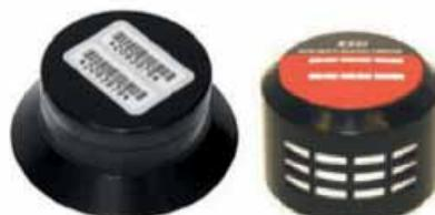
Detector pasivo del tipo de trazas
